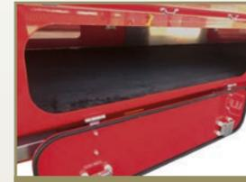
Stauklappen mit Gummidichtung
