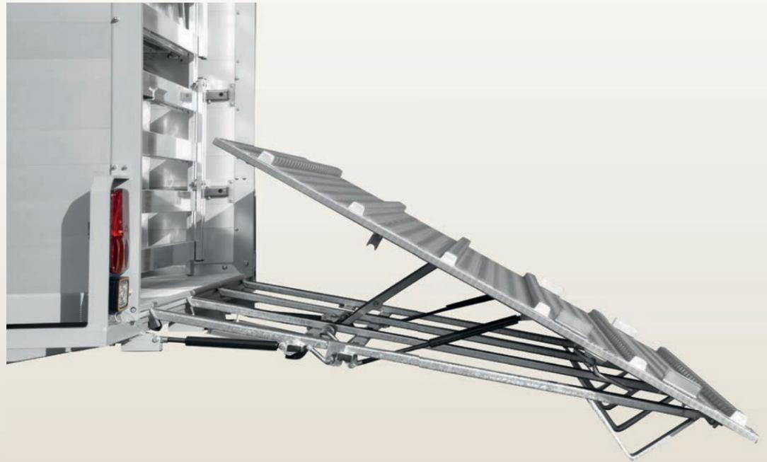
Das neue ALF **2in1** Ladesystem ermöglicht das problemlose Verladen auf zwei verschiedenen Ebenen. Das Verändern der Hinterklappe in eine Rampe für den Zwischenboden ist extrem anwenderfreundlich. Die Klappe lässt sich durch das Ziehen eines einzigen Riegels in die obere Position bringen. Ein Verladen in der oberen Ebene ist jetzt problemlos möglich.
